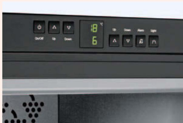
Die präzise **elektronische Steuerung** ist mit einer digitalen Temperatur-Anzeige ausgestattet. Die Temperaturen lassen sich im unteren Bereich zwischen +5 °C und +7 °C, im oberen Bereich zwischen +16 °C und +18 °C einstellen, dazwischen ergibt sich eine Temperaturschichtung.
