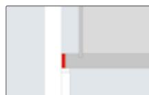
Schrankboden oder Seitenwände mit Gummiband entkoppeln.
