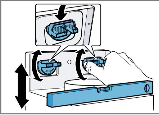
Bei Bedarf das Gerät nach rechts oder links verschieben.
